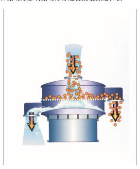
提高圆形振动筛效率的方式有哪些?随着直线振动筛的广泛应用,如何提高圆形振动筛的筛分效率已成为每个人关注的问题。1. 高开口率有利于提高筛选效果。通常,不锈钢焊接筛板具有高开口率,并且振动进料器可以提高筛分效率。2. 调整进料方式,大多数情况下,进料不是沿着全屏宽度,导致筛面不充分利用,影响筛分效率,可以在进料口加入进料装置,材料均匀输入。3. 调整筛机的倾斜角度。适当地减小倾斜度可以减小材料的厚度并实现更薄的筛选。4. 降低直线振动筛筛板挡板率,选择自己清洗的筛板。自动清洁装置减少了阻挡
