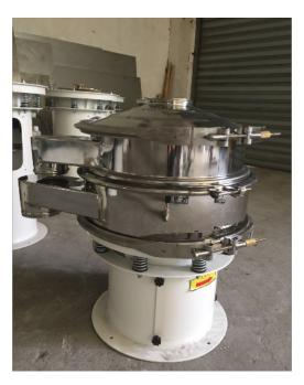
不锈钢振动筛9大特点分析;不锈钢振动筛9大特点:1、体积小,不占空间移动方便,效率高、设计精巧耐用,任何粉类、粘液均可筛分2、筛面可方便地加设清网装置,可有效解决筛面堵塞问题,操作简单、清洗方便。3、网孔不堵塞、粉末不飞扬、可筛至500目或0.028mm□4□杂质、粗料自动排出,可以连续作业。5、独特网架设计,筛网使用时间长久,换网快只需3-5分钟。6、通过调节电机上下偏心块的相位,可改变物料在筛面上的运动轨迹,适合对难筛物料筛分作业。7、通过加设超声转换仪,能有效解决超细物料难筛分的问题。8、出料口可在360圆周内任意调定,便于工艺布置。9、筛机高可以达到五层,建议使用三层。直线振动筛的适应范围和工作原理。重庆微细粉体振动筛
